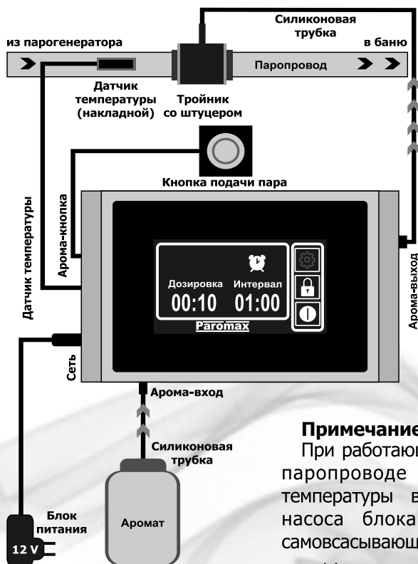
Рис. 2. Схема подключения диспенсера ароматов
