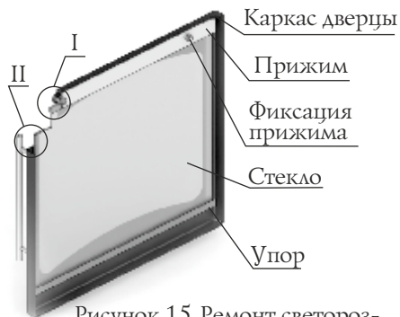
Рисунок 15. Ремонт светопрозрачного экрана дверцы модели «Витра»
