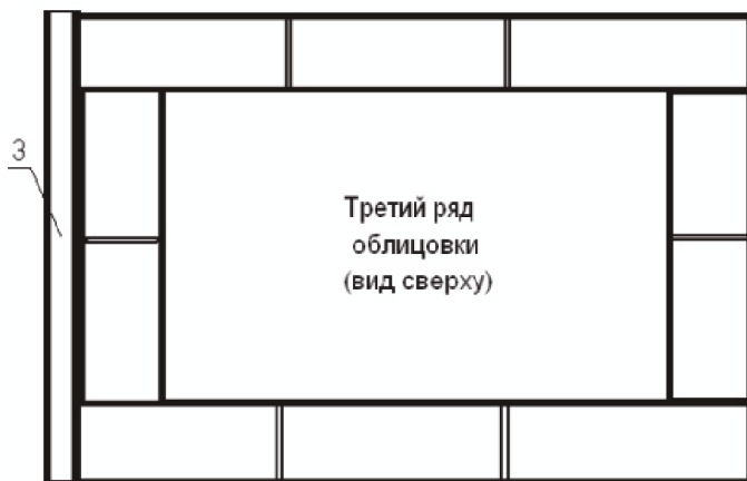
Рис. 2в. Схема сборки третьего ряда облицовки
