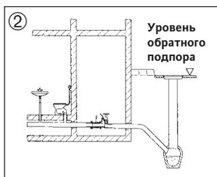
Использование обратного клапана разрешено в технических помещениях, однако он не гарантирует защиту на 100 %.
