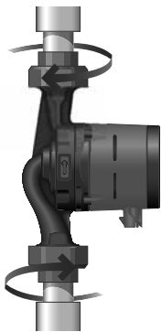
Рис. 3 Монтаж насоса ALPHA2
