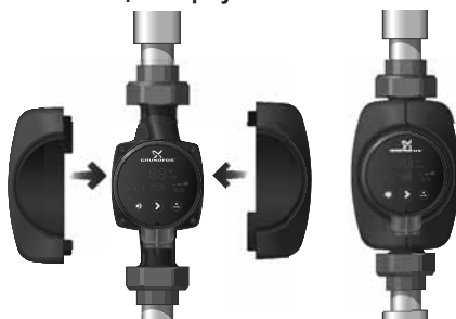
Рис. 8 Изоляция корпуса насоса
