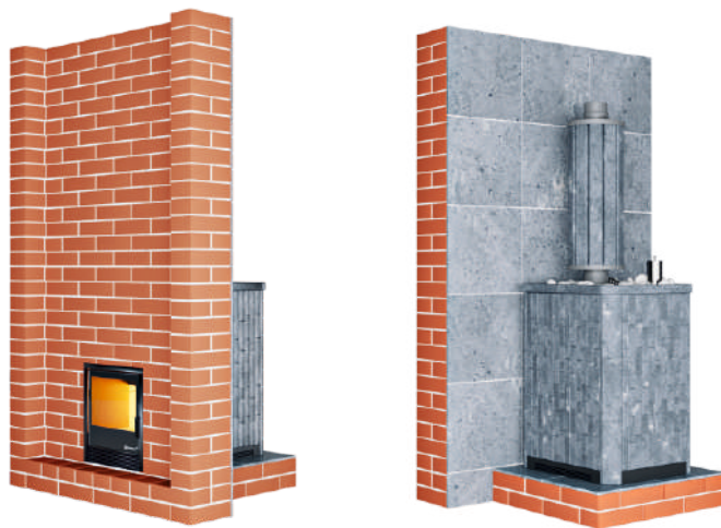
Рис. 5 Проход топочного канала
