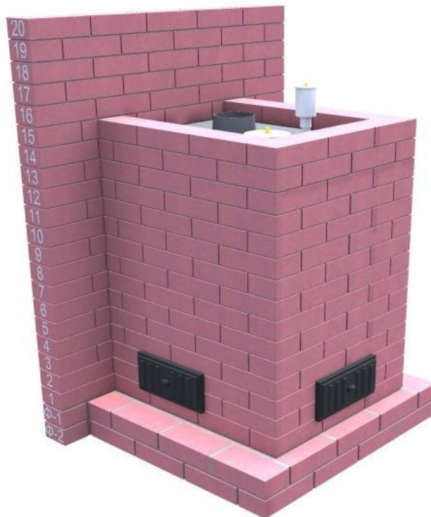
Рис. 5 Внешний вид защитного экрана
