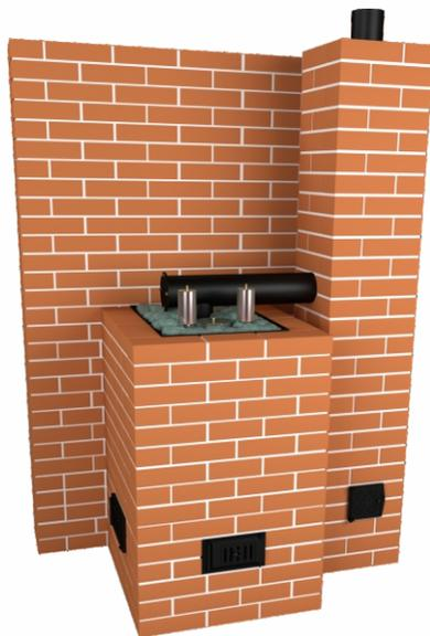
Рис. 7 Пример установки печи с отдельно стоящим дымоходом
