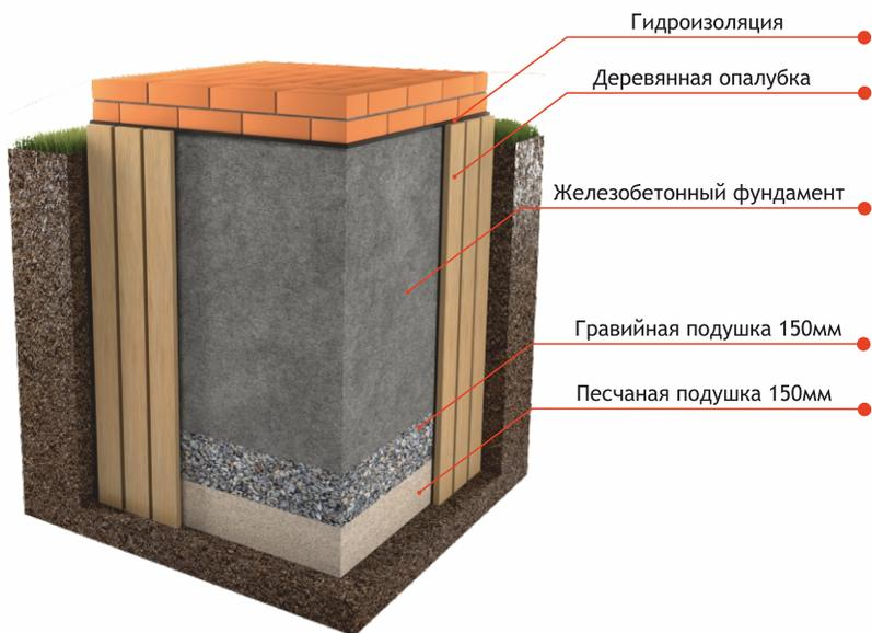
Рис. 3 Схема устройства фундамента
